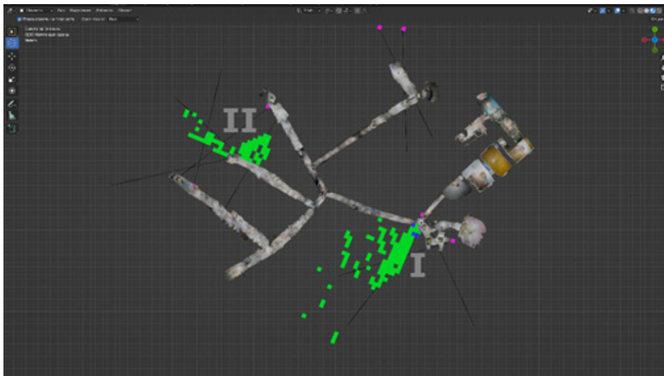
Рисунок 7. Обнаруженные полости на карте Богом зданных пещер: склеп (область I) и Троицкая улица (область II)
