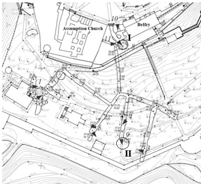
Рисунок 4. Схема расположения детекторов в пещерах Свято-Успенского Псково-Печерского монастыря. Треугольниками обозначено положение детекторов. Острые концы треугольников указывают направление их обзора. Два круга, обозначенные цифрами I и II, показывают исследуемые объекты (склеп за иконой на входе в пещеры и область за тупиком Троицкой улицы)
