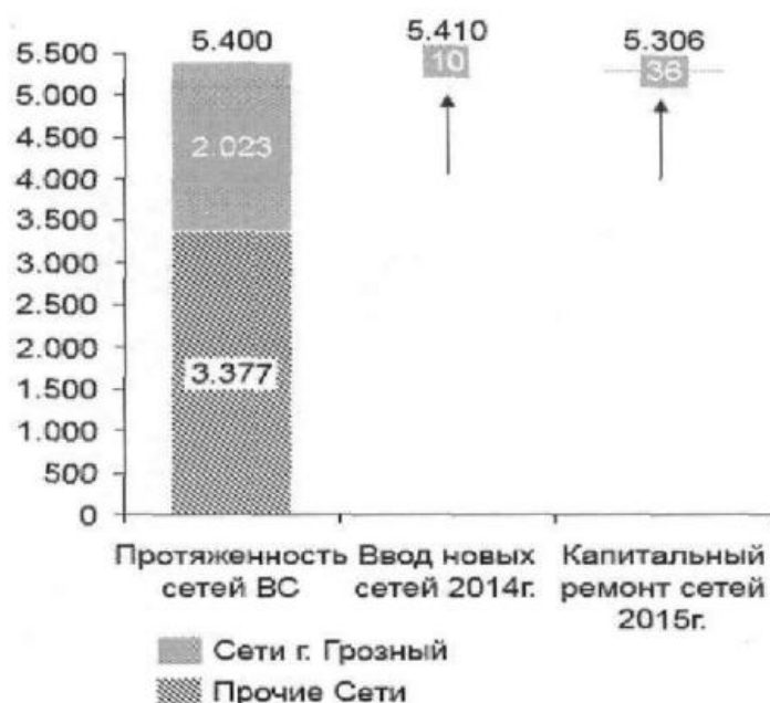
Рисунок 4. Протяженность сетей ВС г. Грозного, количество вновь вводимых сетей и сетей, подверженных капитальному ремонту
