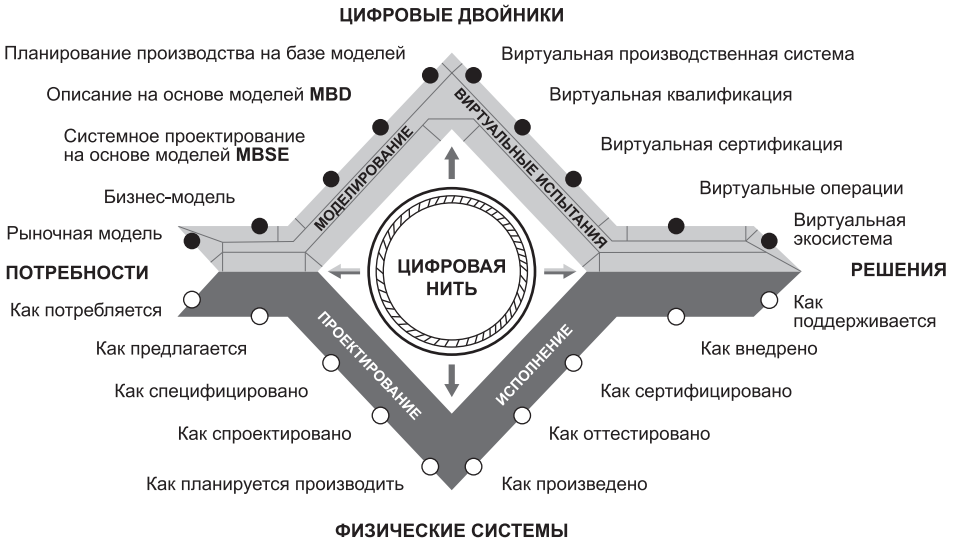
Рис. 1.59. Схема, поясняющая основные элементы и функции ЦД на разных этапах жизненного цикла. Источник: Boeing
