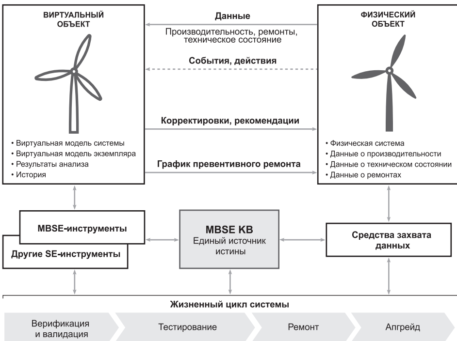
Рис. 1.53. Концепция ЦД как концепция, опирающаяся на MBSE-методологию. Источник: Leveraging Digital Twin Technology in Model-Based Systems Engineering
